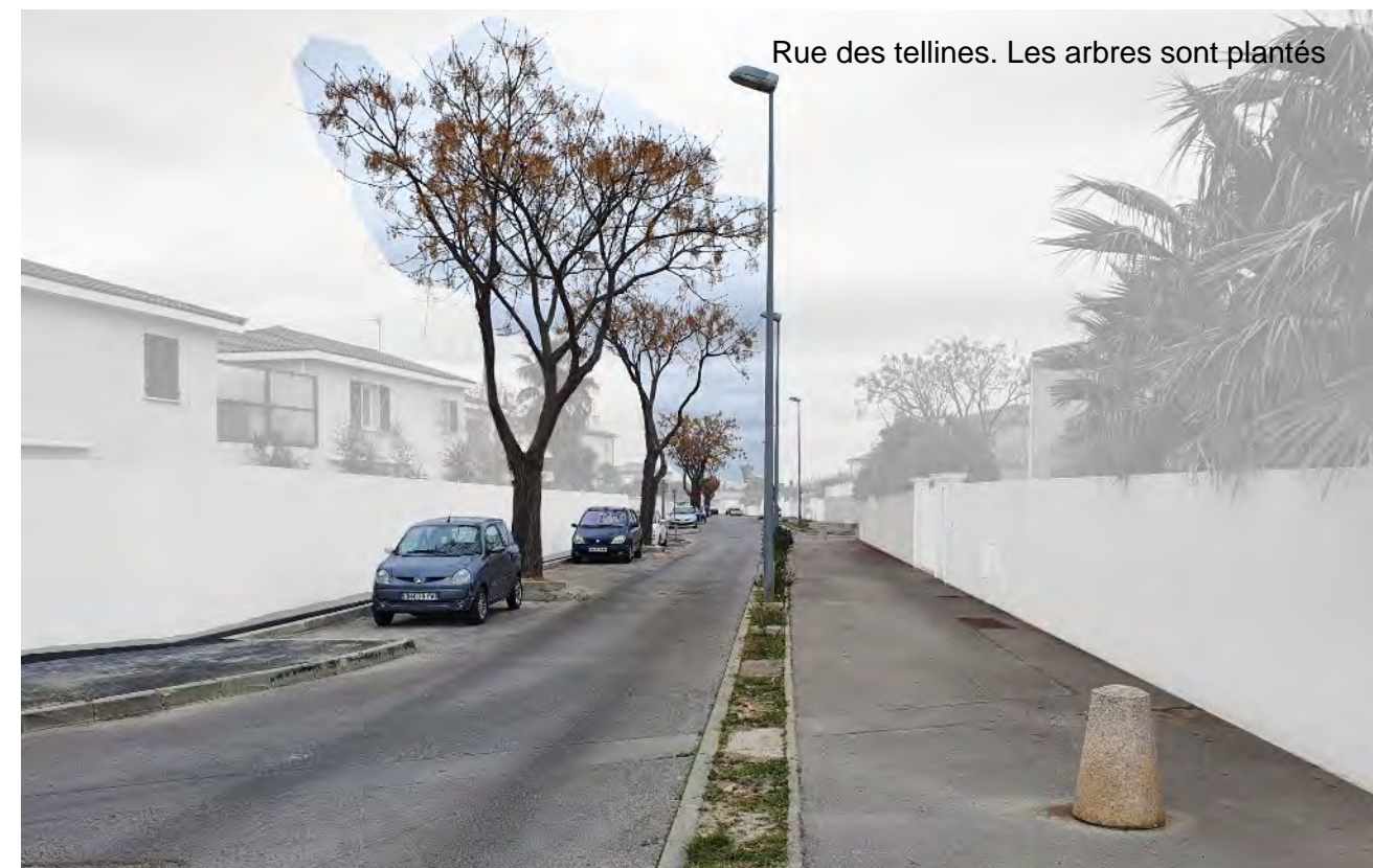
Arbre planté en voirie ayant une surface perméable en pied beaucoup trop faible. Par ailleurs on observe de nombreux arbres peu développés du fait de fosses de plantation trop modestes
