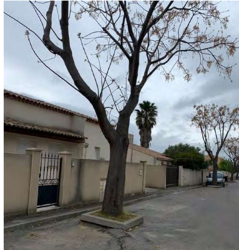
Arbre planté en voirie ayant une surface perméable en pied beaucoup trop faible. Par ailleurs on observe de nombreux arbres peu développés du fait de fosses de plantation trop modestes
