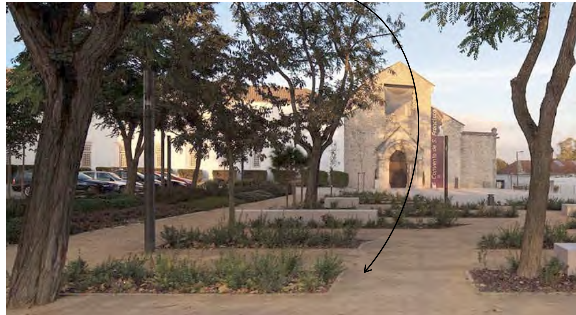
Stabilisé mécanique : Mélange de sables et de graves, compacté mécaniquement, adapté aux aires de jeux, square, et cheminement piéton. Revêtement perméable
